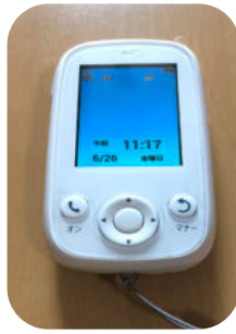
▲緊急通報装置
